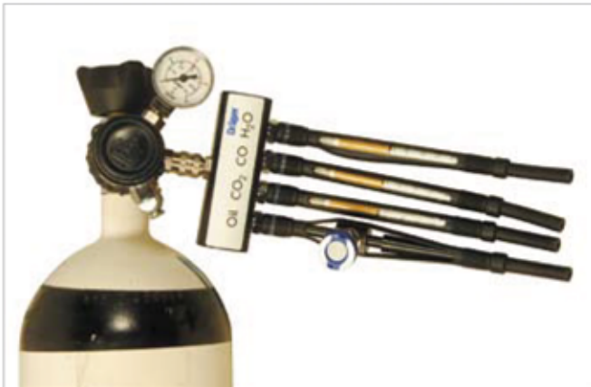
Messung der Luftqualität direkt an der Druckluftflasche
