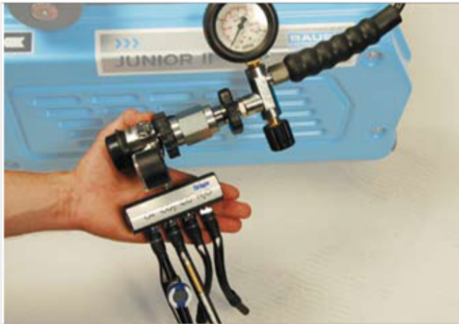
Messung der Luftqualität am Kompressor
